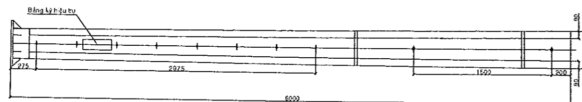
CHI TIẾT MẶT DỰNG ĐOẠN GỐC 06 MÉT CHO TRỤ 16 MÉT
